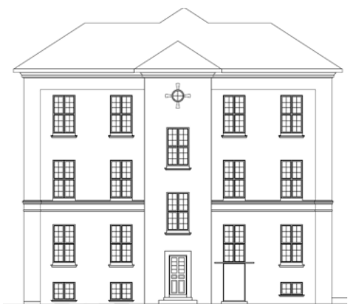
Fig.42. Baldakinen over elevatordøren på Sønderhus' nordfacade må skiftes ud med en baldakin med samme udformning. Også selve elevatordøren må skiftes ud. Ved udskiftning skal døren have samme udformning som Sønderhus' oprindelige adgangsdøre i henhold til de overordnede bestemmelser.
