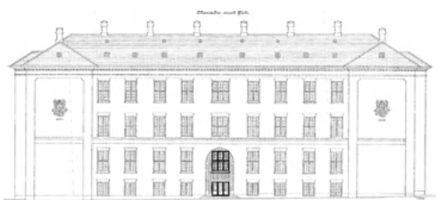
Fig.41. Den oprindelige port på Sønderhus' østfacade må retableres.
